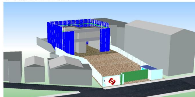
② 仮設養生足場組立（防音パネル）
