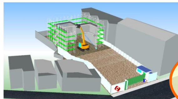
④ 上屋解体Ⅰ（中央部解体）
