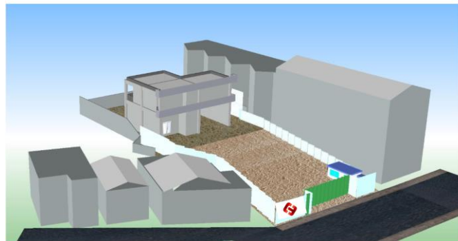
① 準備工事・家屋調査・仮囲い・工事事務所等整備
