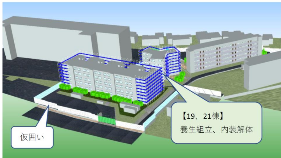
STEP 1 (仮囲い、養生足場組立、内装解体)
