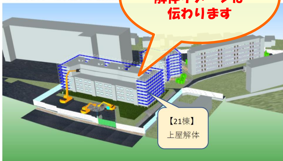
STEP 2 (21棟 上屋解体)
