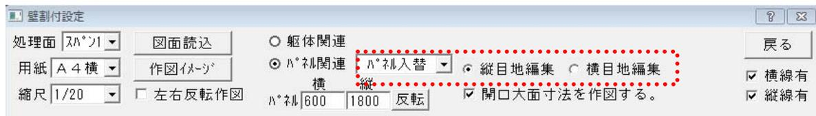
① **縦目地編集**か**横目地編集**かを選択します。編集可能な方向の線がピンク、不可の方向は青線で表示になります。
