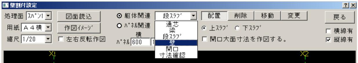
壁の配置基準を芯配置と面配置から選びます。
