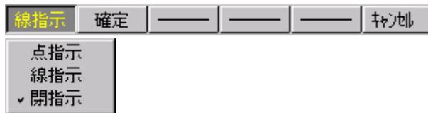
閉指示で、画面上のスラブの内側をクリックします。範囲が赤く表示されます。うまく指示できない場合は、線指示、もしくは点指示(交 endpoint 等での指示)で再度外形を指示してください。
